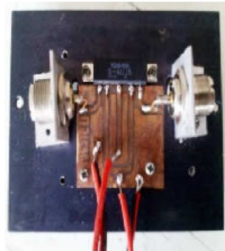
Gambar 9 Hasil perancangan Amp Transmit
