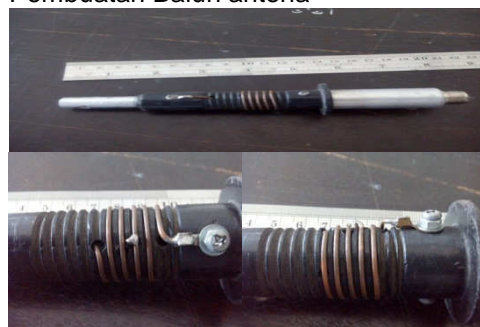
Gambar 19. Hasil pembuatan dan penempatan posisi tap lilitan.
