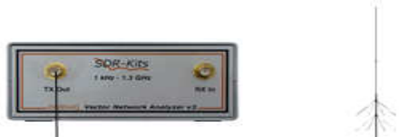
Gambar 8. Konfigurasi pengukuran antenna menggunakan VNWA
