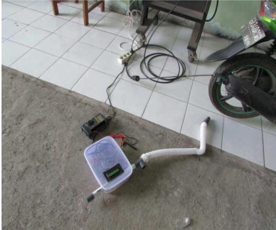
Gambar 17. Pengukuran emisi Gas buang kendaraan dengan alat standard dan Rancangan
