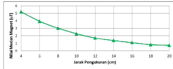
Gambar 29 Grafik perbandingan antara besar nilai medan magnet dan jarak pengukuran pada frekuensi 5 kHz.
