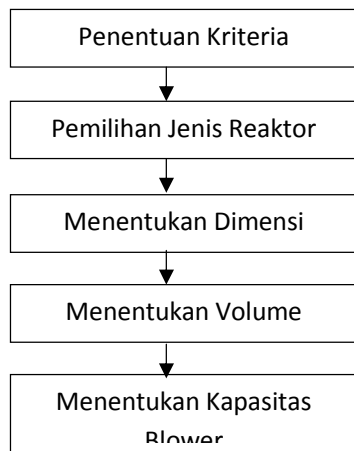
Gambar 1. Diagram alir perancangan reaktor gasifikasi biomassa
