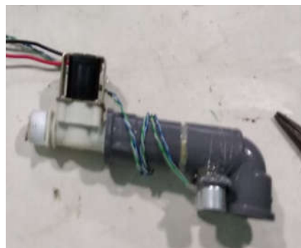
Gambar 10. Kran wudhu otomatis dan sensor jarak
