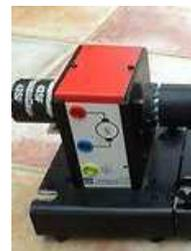
Gambar 10. Tachogenerator Sebagai Sensor Kecepatan (Ardiansyah, 2014)
