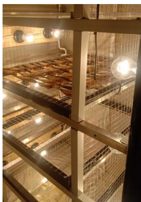
Gambar 7. Pengujian Pengeringan Ikan Bage
