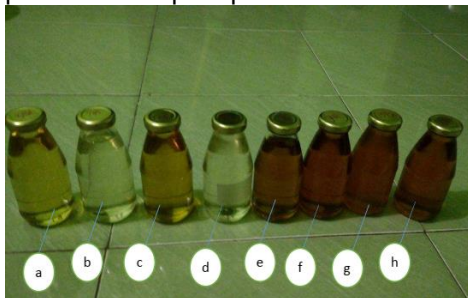
Gambar 1. Sampel pengujian minyak transformator; nomor a: 3, b: 4, c: 5, d: 6, e: 8, f: 9, g: 10, dan h: 11 tahun penyimpanan
