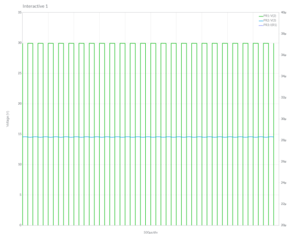
Gambar 13. Hasil Pengujian PWM 100 kHz dan duty cycle 30%
