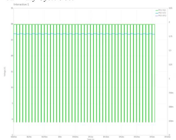
Gambar 23. Pengujian Hasil Pengujian PWM 100 kHz dan duty cycle 90%
