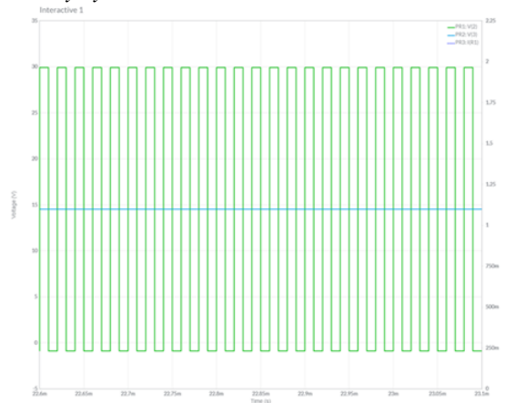
Gambar 17. Hasil Pengujian PWM 50 kHz dan duty cycle 50%
