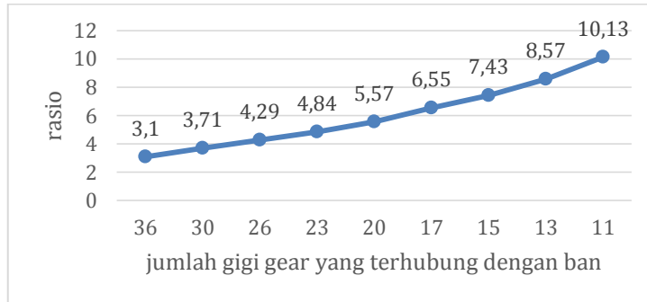
Gambar 3. Grafik perbandingan jumlah gigi gear yang terhubung ban dengan rasio gear
