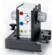
Gambar 11. Tachogenerator Sebagai Sensor Kecepatan
