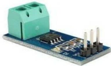
Gambar 5. Bentuk dari sensor ACS712
